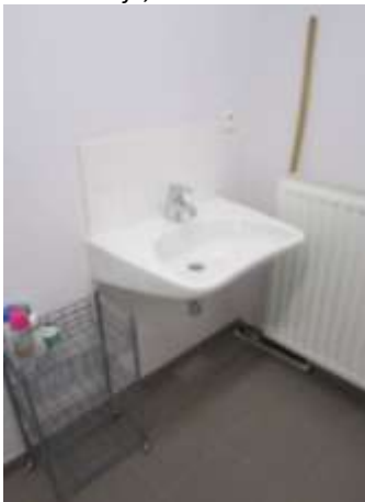
Wastafelmodel met afgeronde voorzijde, ergonomisch model. Hierdoor is de kraan en de waterstraal gemakkelijker bereikbaar Kids, © Enter vzw
