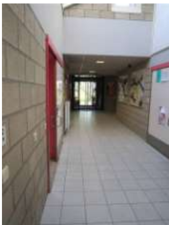
Gang gedimensioneerd op dubbele passage. Sint Lodewijk, ©Enter vzw
