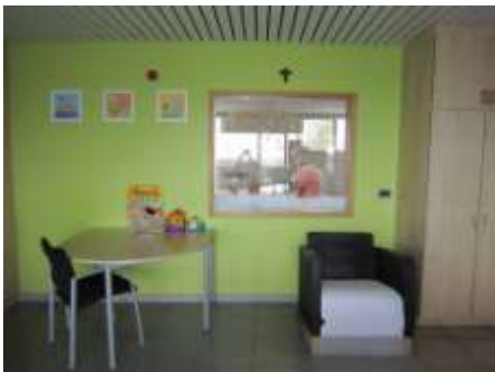
Raam tussen leefruimte en badkamer, spiegelen en afsluitbaar met een gordijn.
