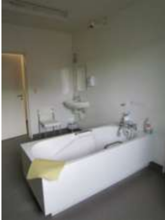
Vrijstaand bad op normale hoogte, met ingewerkte handgrepen en onderstaanbaar uitgevoerd. Maria Ter Engelen, © Enter vzw
